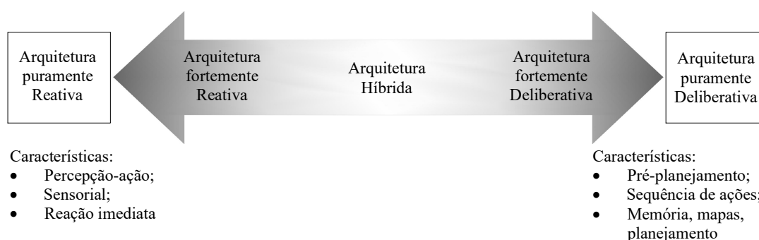
Figura 2 – Arquiteturas de robôs móveis.
