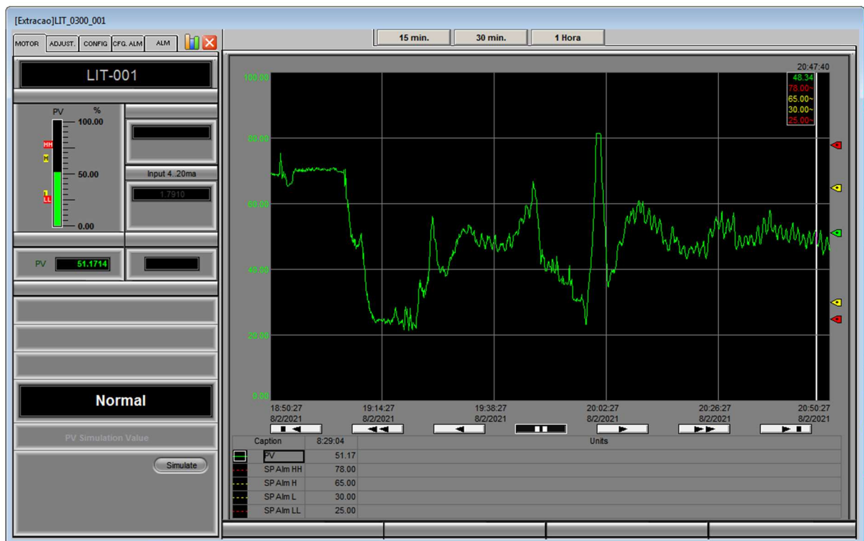
Figura 44 – Nível de Lâminas durante partida antes do PID.
