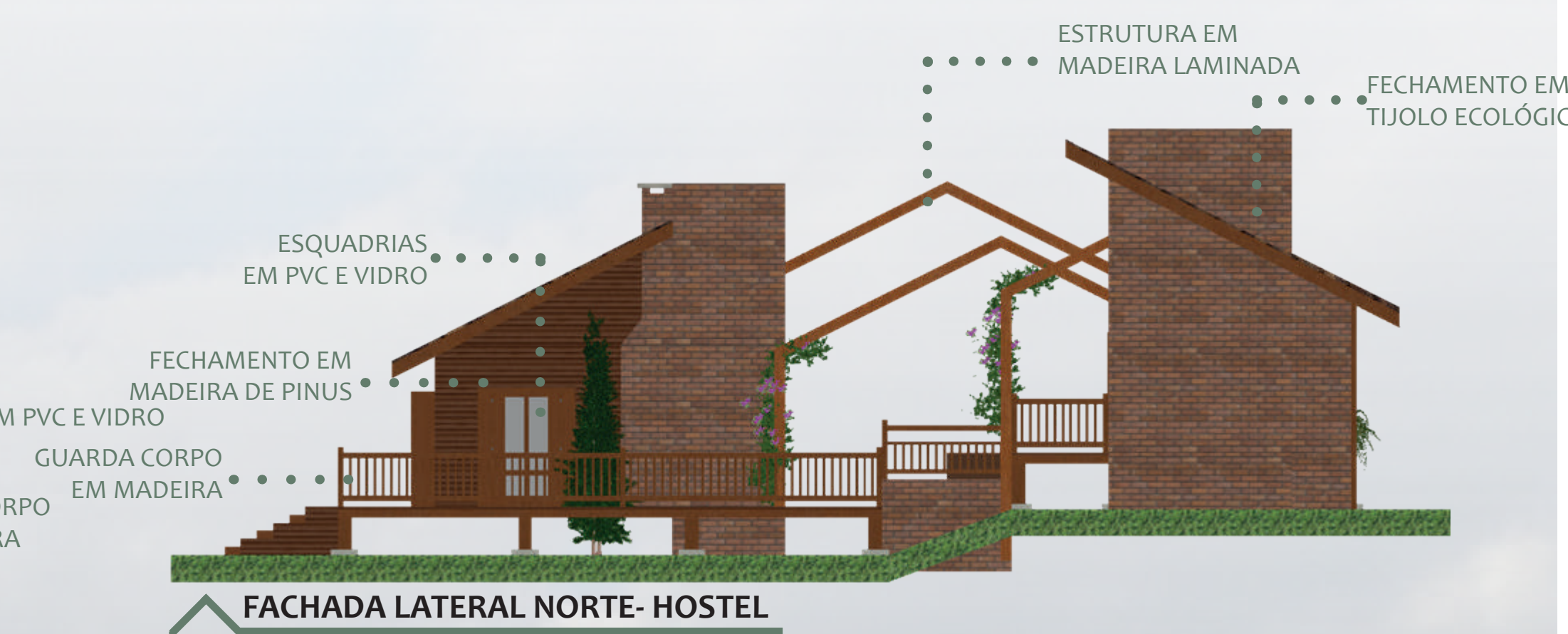
FACHADA LATERAL NORTE- HOSTEL ESCALA 1:100
