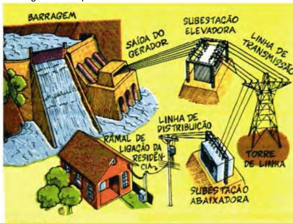
Figura 1 - Esquema do sistema Elétrico de Potência - SEP
