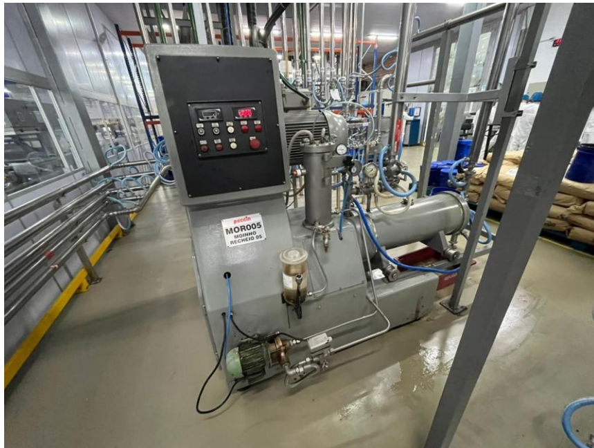
Figura 12 - Processo de Moagem totalmente manualmente
