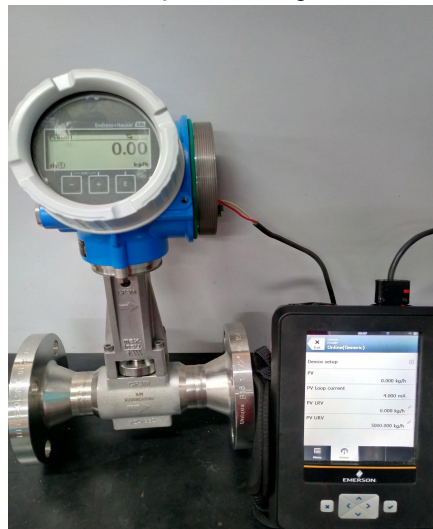
Figura 21 – Informações obtidas pelo comunicador hart
