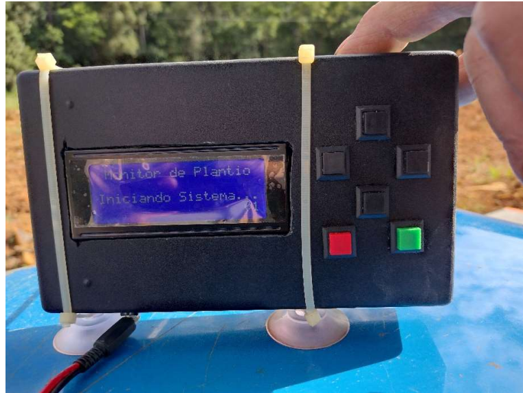
Figura 30 – Ponto de instalação da interface IHM
