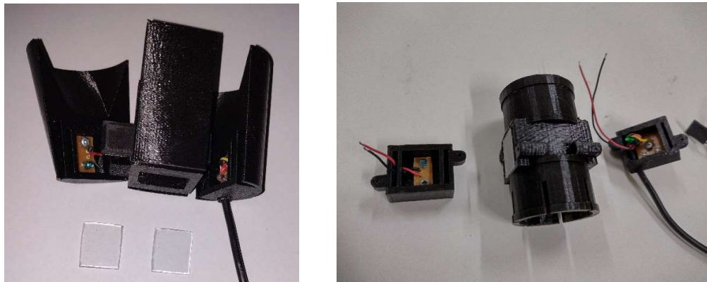
Figura 23 – Partes dos sensores de semente e adubo
