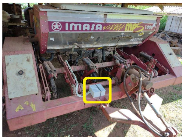
Figura 28 – Ponto onde foi instalado o módulo processador de sinais
