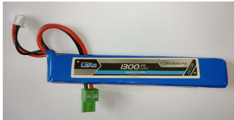
Figura 11 – Bateria Lipo 1300mAh 7.4V
