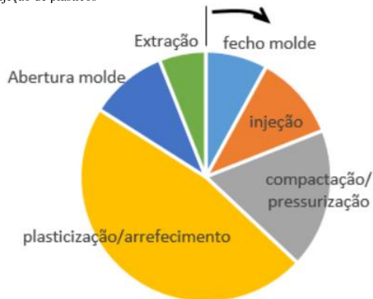
Figura 3 - Ciclo de injeção de plásticos
