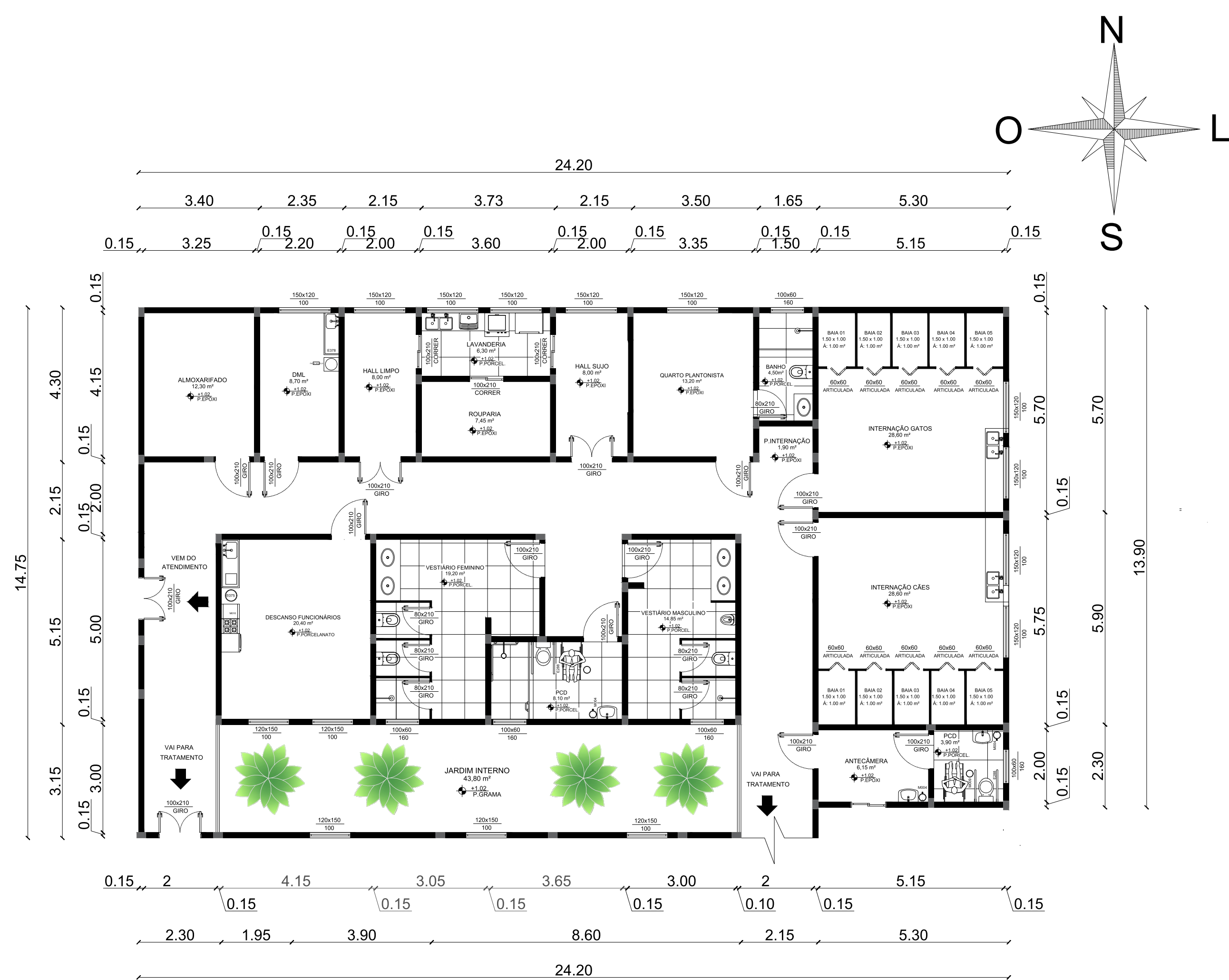
17 PLANTA TÉCNICA SERVIÇO E TRATAMENTO esc 1 / 100
