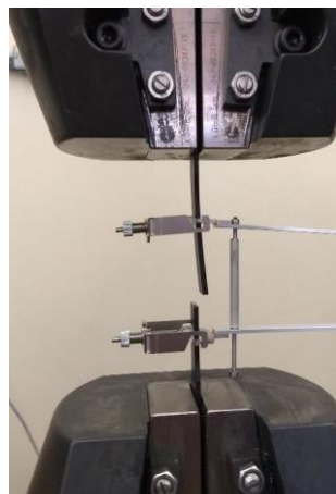
Figura 9 - Ruptura do material.
