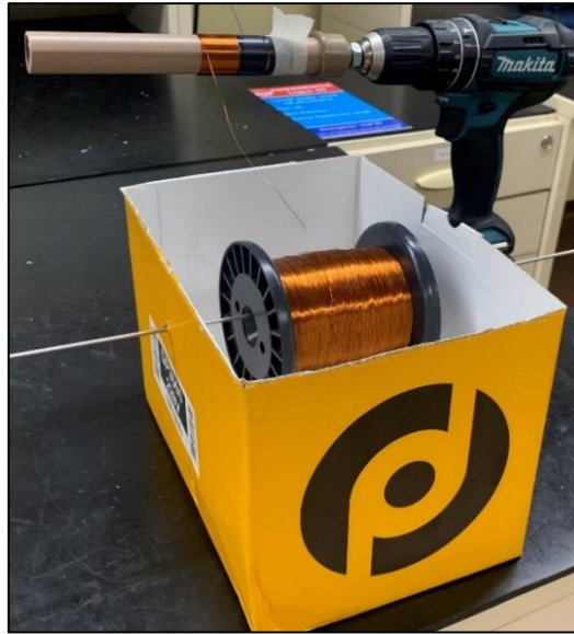
Figura 26 – Montagem das bobinas de excitação e detecção.
