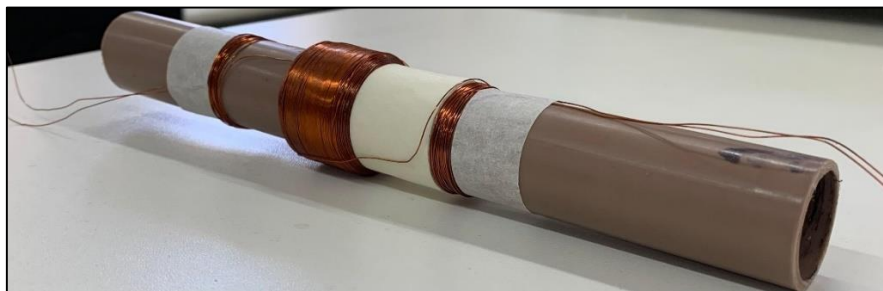
Figura 25 – Bobinas do sensor de partículas ferrosas.
