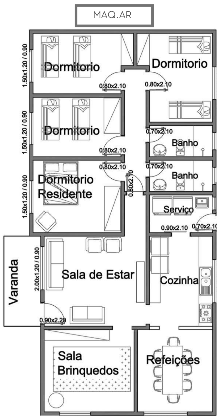
PLANTA BAIXA MOBILIADA - EQUIPAMENTOS 1 E 2 ESCALA: 1/100
