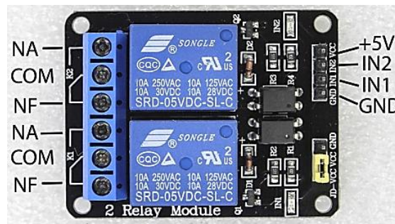
Figura 33 - Pinagem módulo relé
