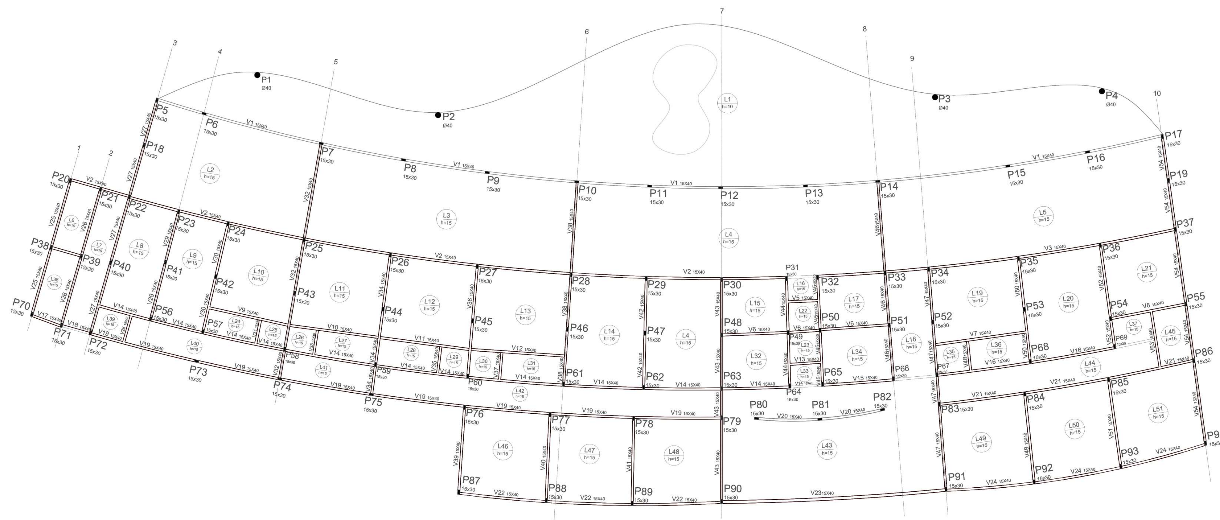
1 Planta Estrutural praça alimentação Esc: 1/150
