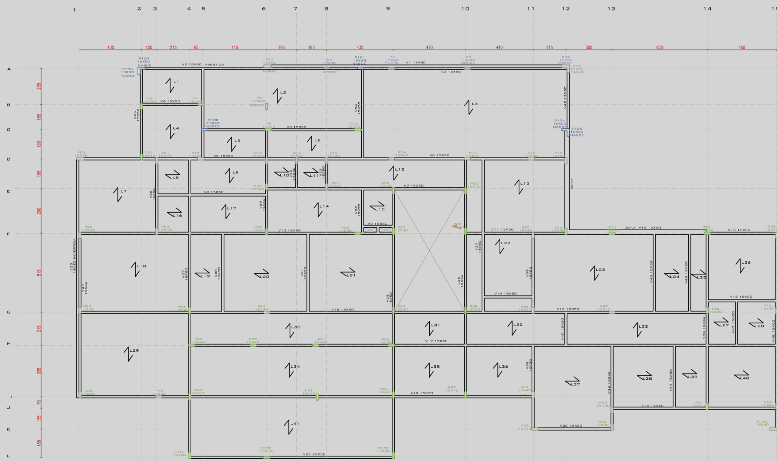
PLANTA DE FORMA NÍVEL SEGUNDO PAVIMENTO ESC:1/150
