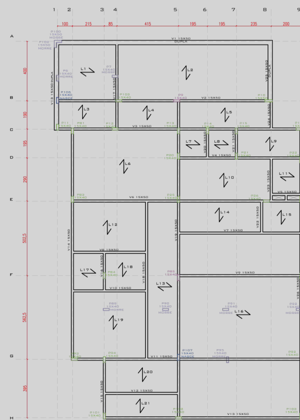
PLANTA DE FORMA NÍVEL TERCEIRO PAVIMENTO ESC:1/150
