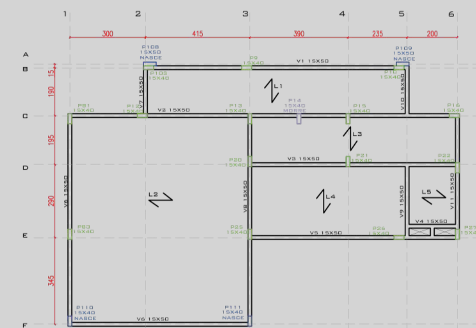
PLANTA DE FORMA NÍVEL QUARTO PAVIMENTO ESC:1/150
