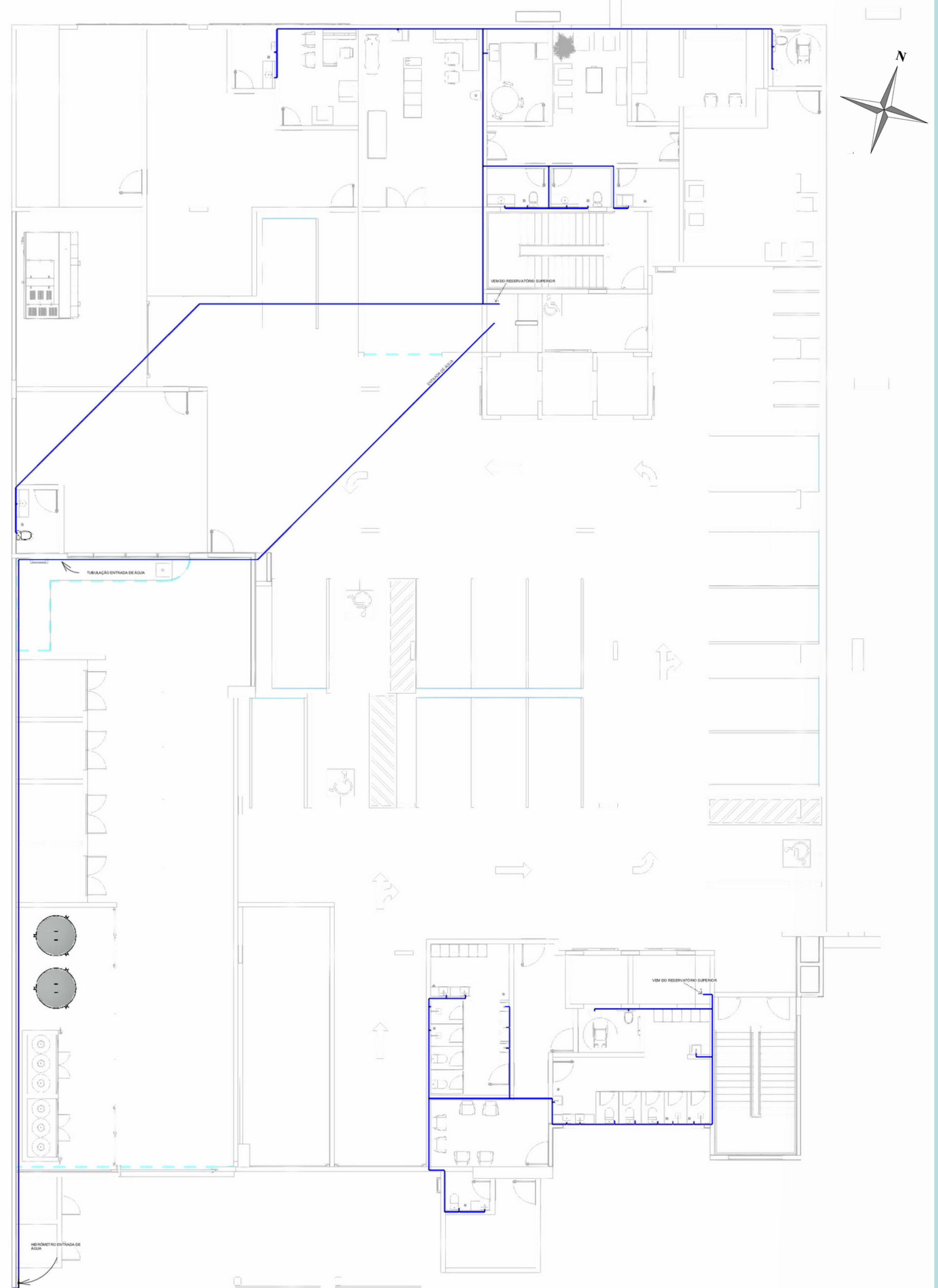
PAVIMENTO TÉRREO SISTEMA DE ÁGUA FRIA ESC:1/150
