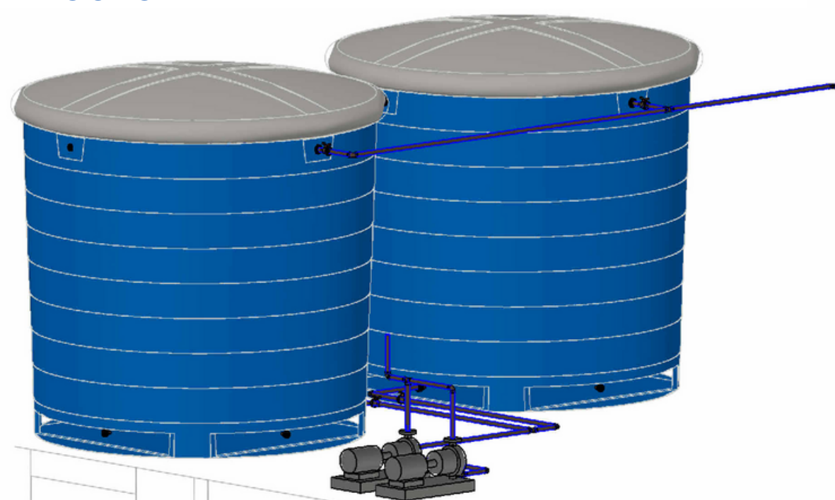
RESERVATÓRIO INFERIOR ESC:1/50
