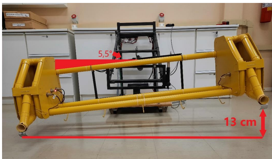
Figura 52 - Plataforma totalmente inclinada para o lado esquerdo do operador.
