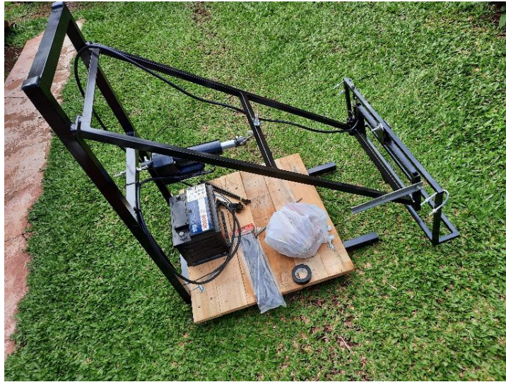
Figura 36 - Visão lateral da estrutura do pescoço, com base de madeira, e pistões fixados.
