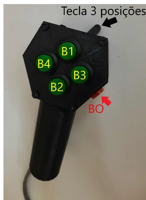
Figura 41 - Alavanca multifunção finalizada.
