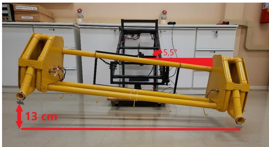
Figura 51 - Plataforma totalmente inclinada lado direito do operador.
