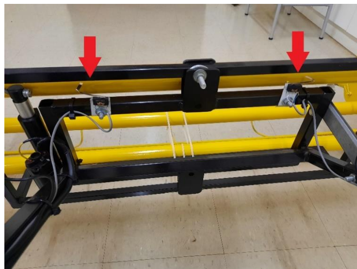
Figura 39 - Indicação das chaves fim de curso que limitam a inclinação da plataforma.
