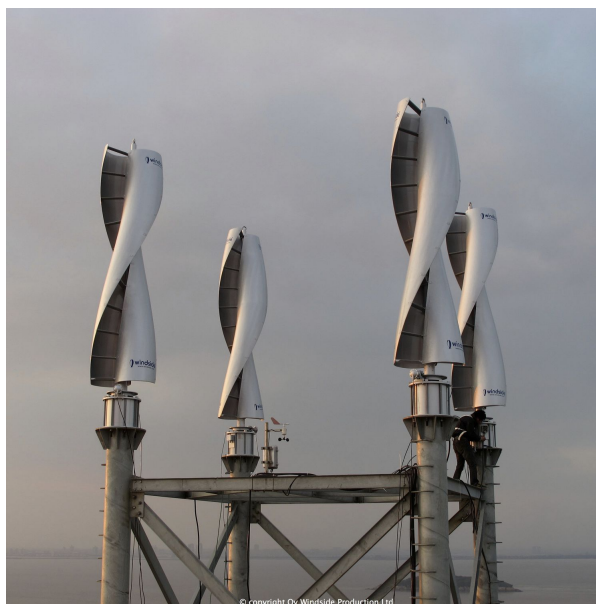
Figura 5 – Exemplo de aerogerador do tipo Savonius helicoidal
