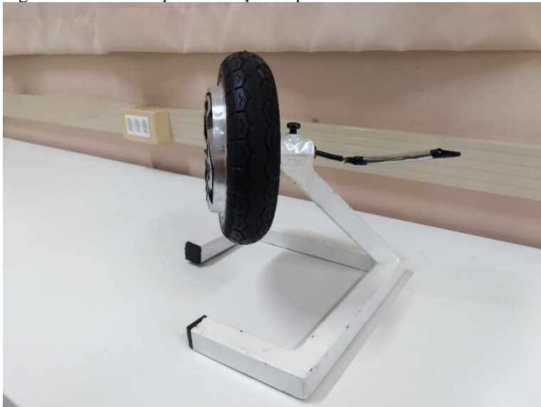
Figura 18 - Bancada para obtenção de parâmetros dos motores
