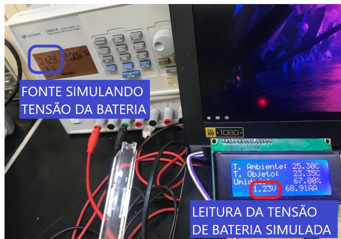
Figura 49 – Validação da medição de tensão da bateria
