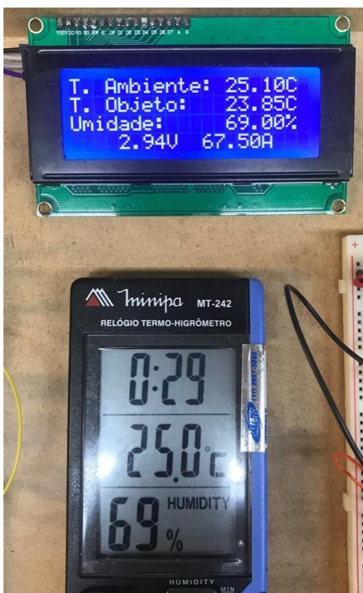
Figura 47 – Validação da medição de temperatura e umidade ambiente
