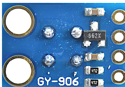
Figura 17 – PCB traseira do MLX90614
