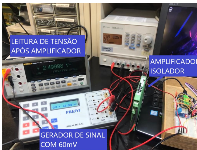
Figura 50 – Verificação da operacionalidade do condicionador de sinal
