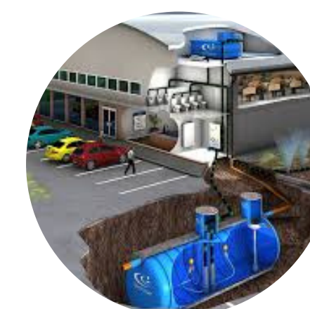
Aproveitamento água da chuva
