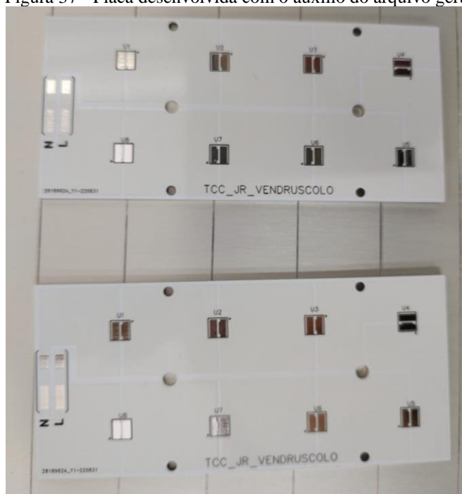
Figura 37 - Placa desenvolvida com o auxílio do arquivo gerber
