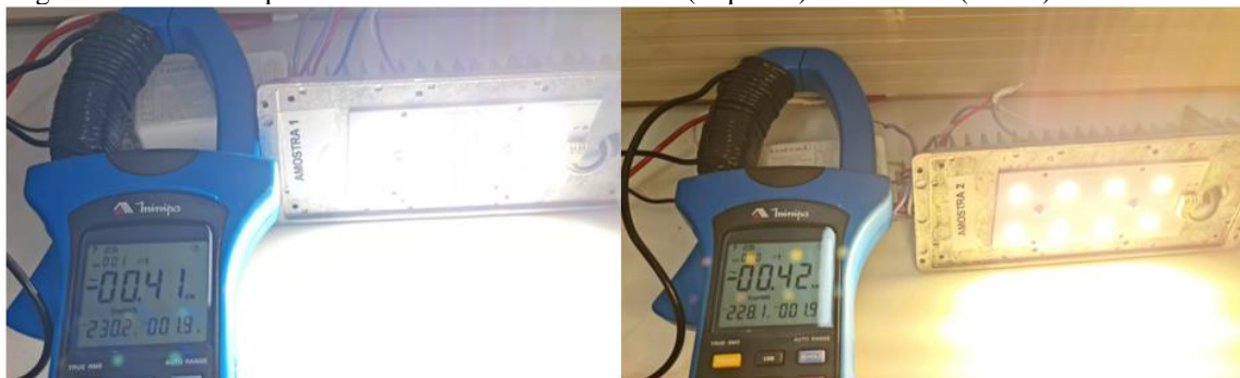
Figura 42 - Testes de potências realizados nas amostras 1 (esquerda) e amostra 2 (direita)
