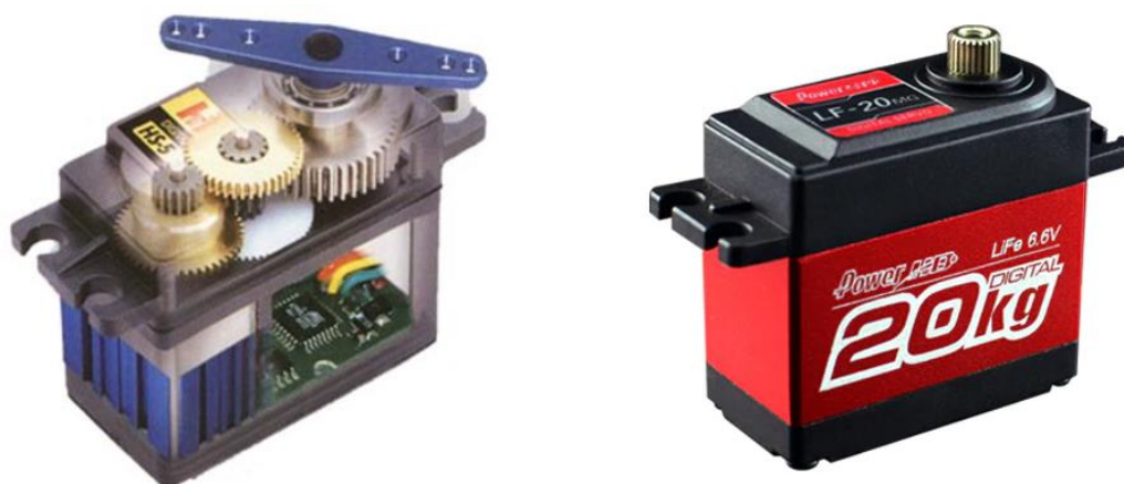
Figura 12 – Estrutura interna de um servomotor (esquerda) e exemplo de modelo comercial (direita)
