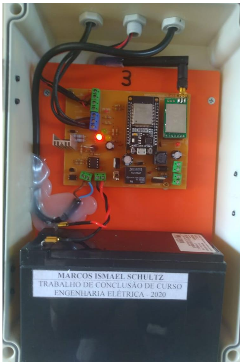
Figura 23 – Circuitos internos dos módulos de medições
