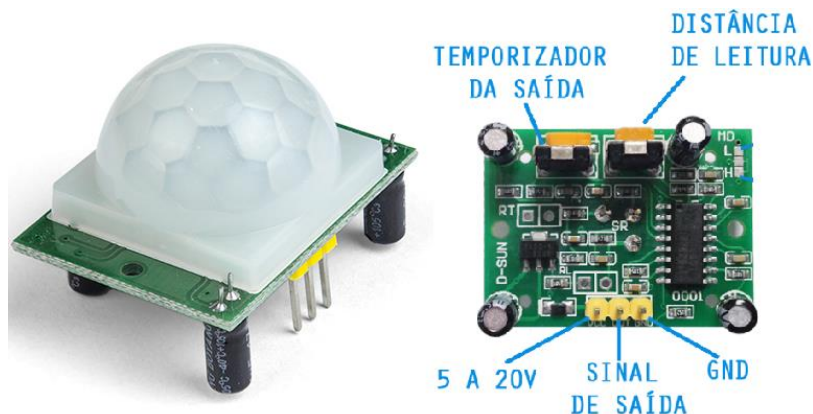
Figura 16 - Sensor de Presença PIR - HC-SR50
