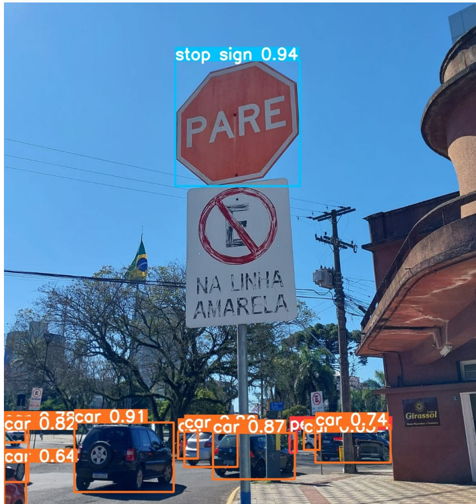
Figura 15 – Conferência de classe "Stop sign" existente
