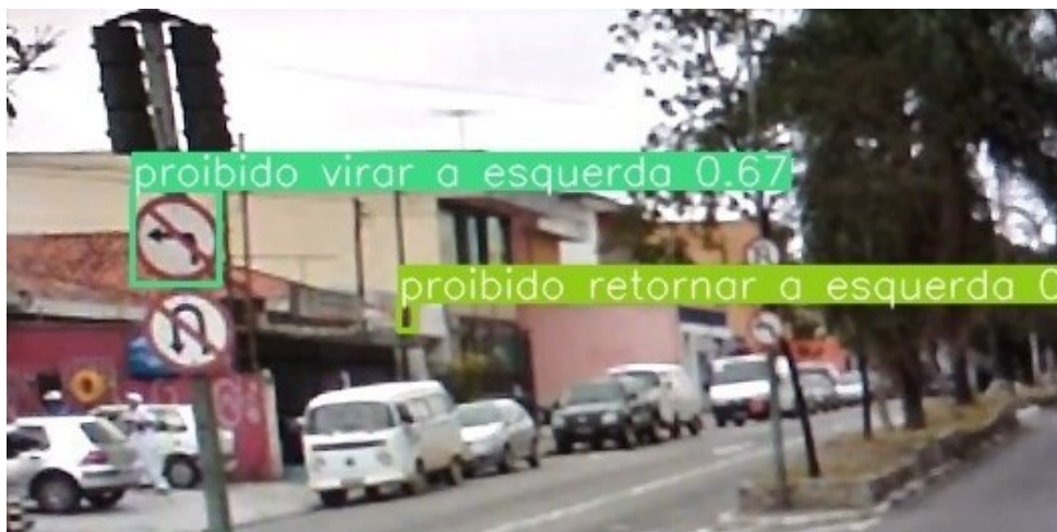
Figura 45 – Exemplo de detecção de placa distante
