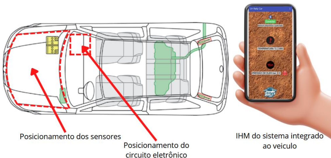
Figura 5 – Representação do sistema de telemetria.
