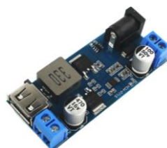
Figura 32 – Conversor DC/DC com saída fixa em 5 V.
