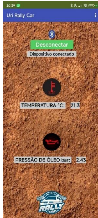
Figura 42 – Interface da IHM no aplicativo Android com exibição de temperatura e pressão.
