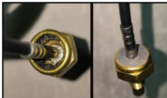
Figura 29 – Adaptação sensor DS18B20.
