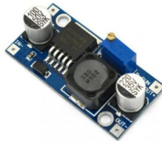
Figura 9 – Regulador buck LM2596 para rebaixamento da tensão de entrada.
