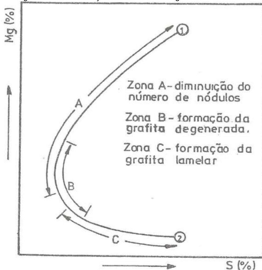
Figura 18: Demonstração dos efeitos do magnésio com o enxofre.
