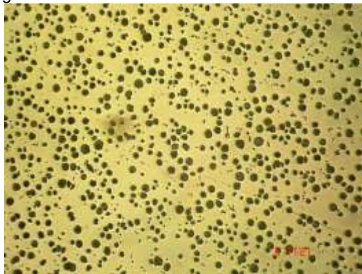
Figura 4: Microestrutura do ferro fundido nodular.
