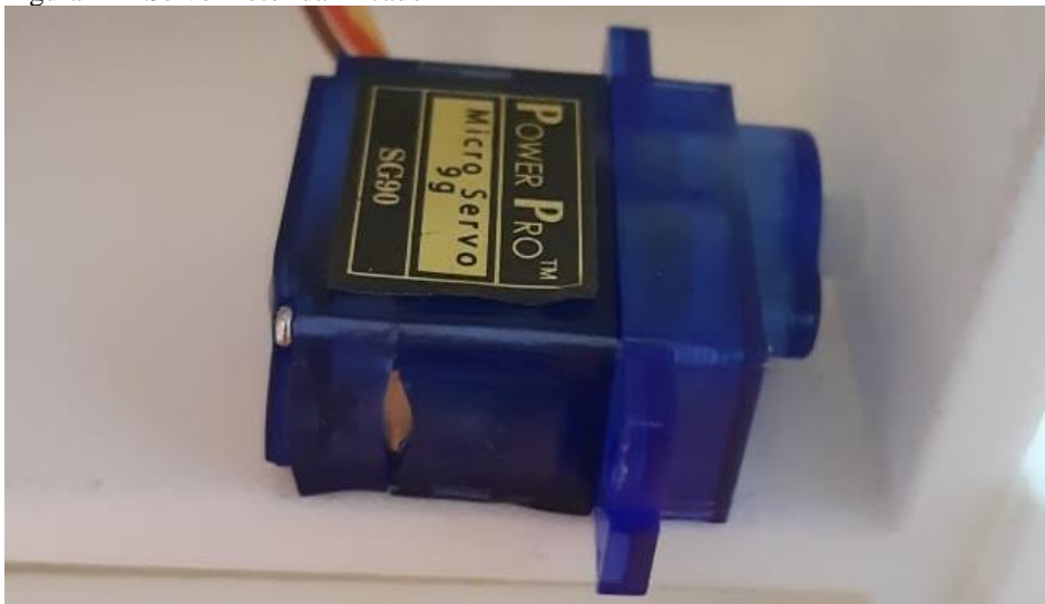
Figura 22 - Servo motor danificado
