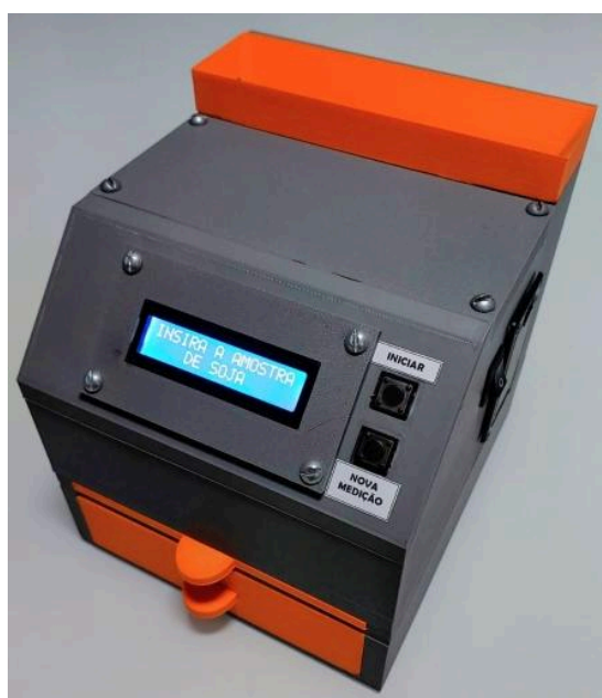
Figura 8 - Medidor de umidade de grãos de soja desenvolvido
