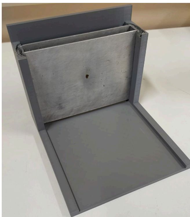
Figura 10 - Capacitor sensor fixado na estrutura do protótipo
