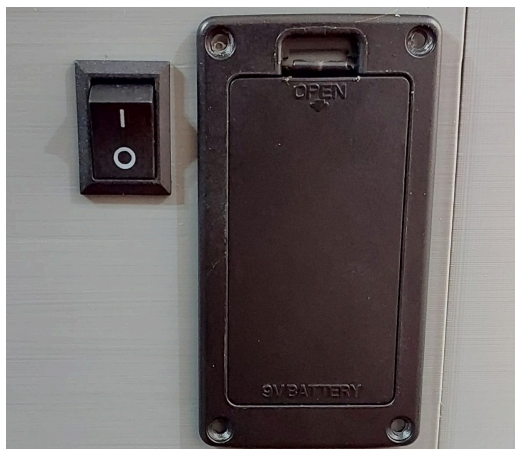
Figura 26 - Chave gangorra on/off e suporte da bateria do protótipo
