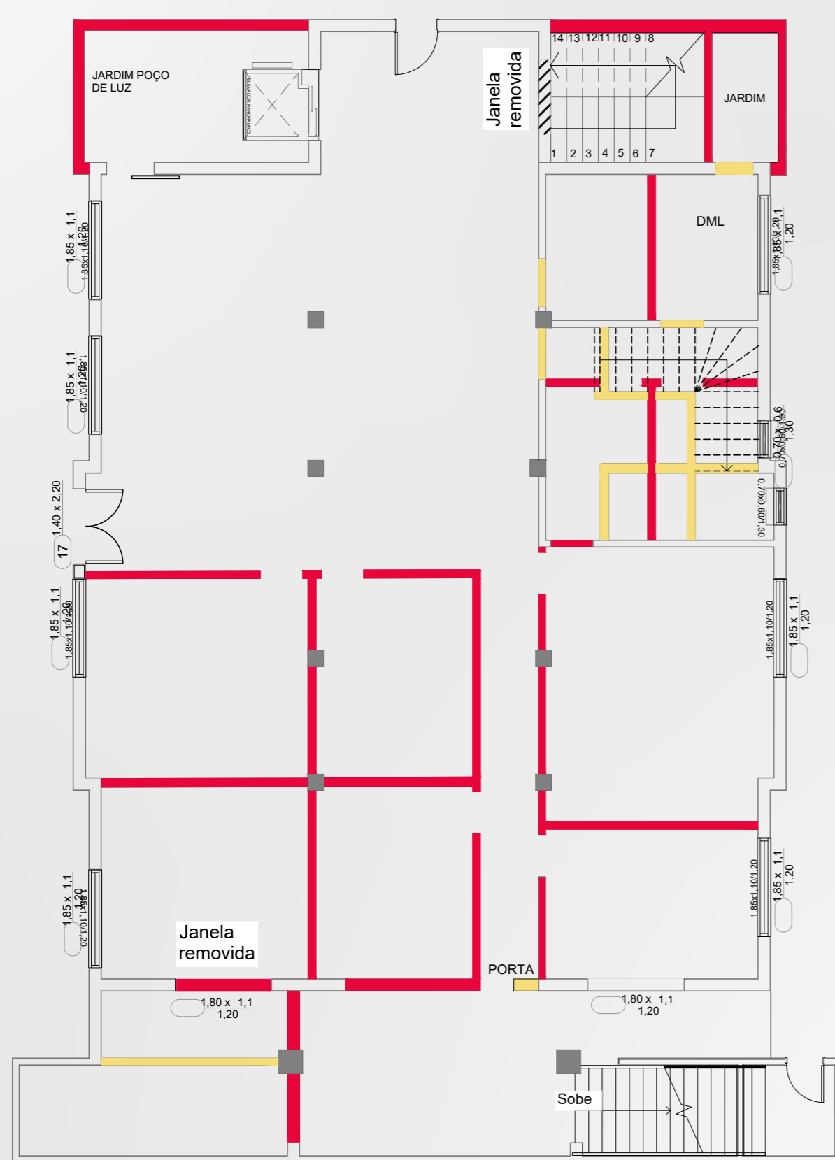
DEMOLIR E CONSTRUIR SUBSOLO escala 1:100
