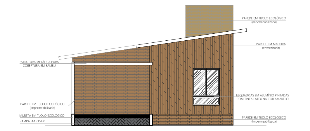
FACHADA SUDOESTE - TIPO 4 (PRINCIPAL) ESC 1/100
