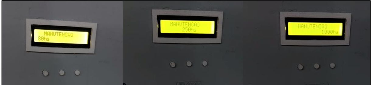
Figura 53 - Telas de aviso de manutenção
