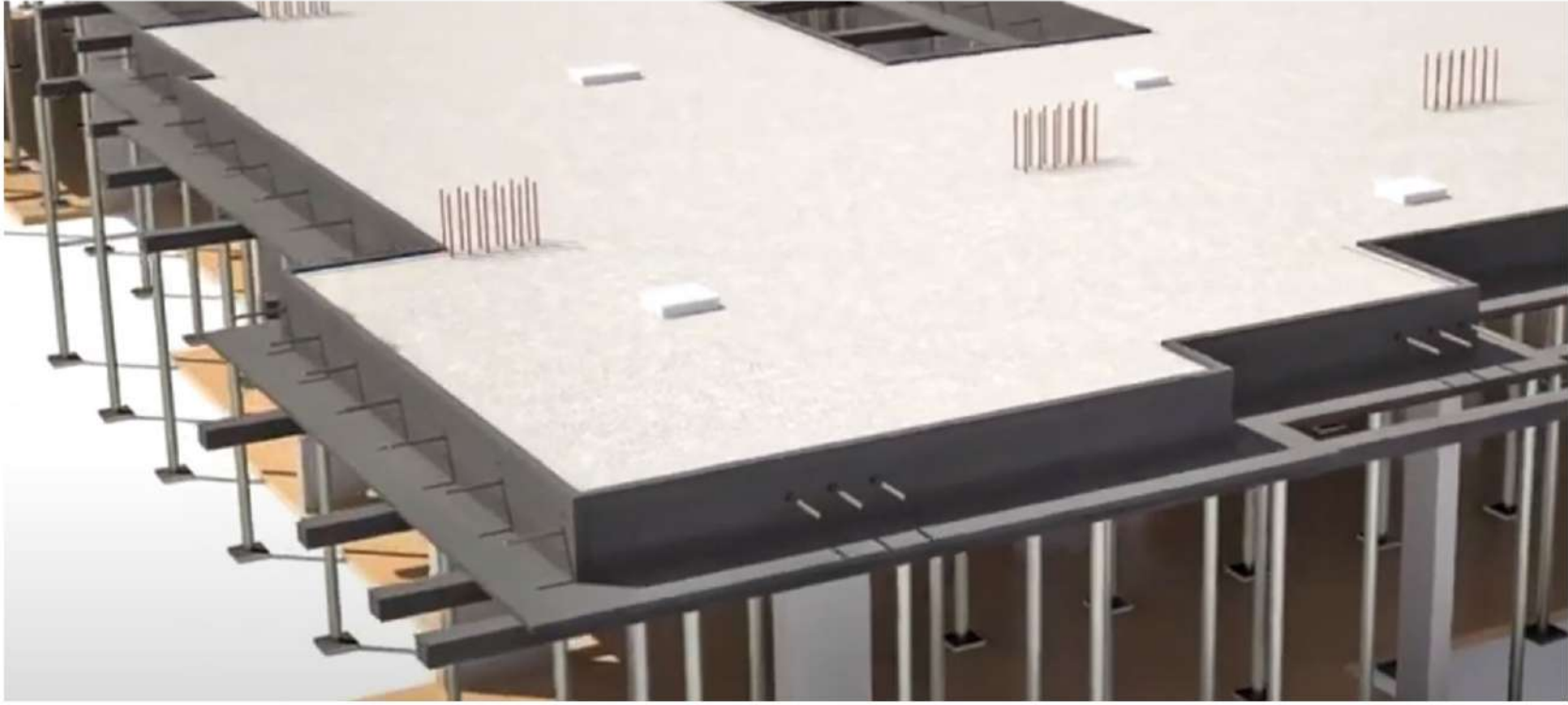
CONCRETAGEM DA LAJE
