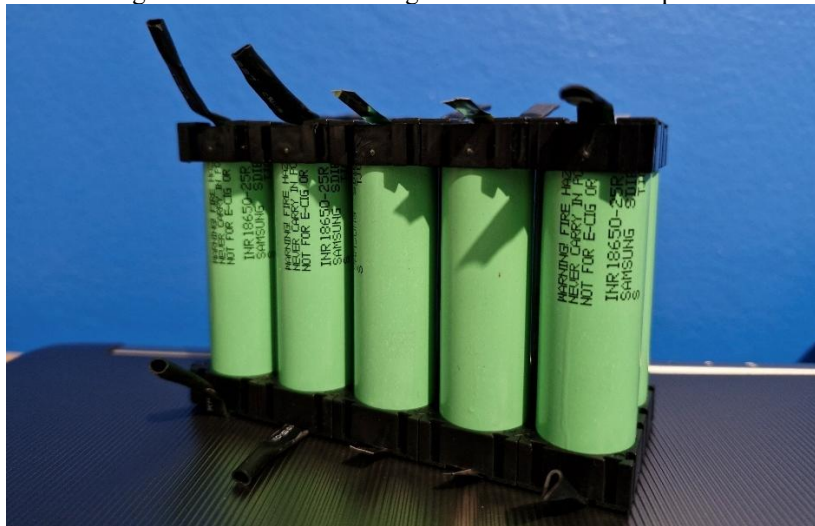
Figura 3.1: Células Samsung INR 18650-25R no suporte.
