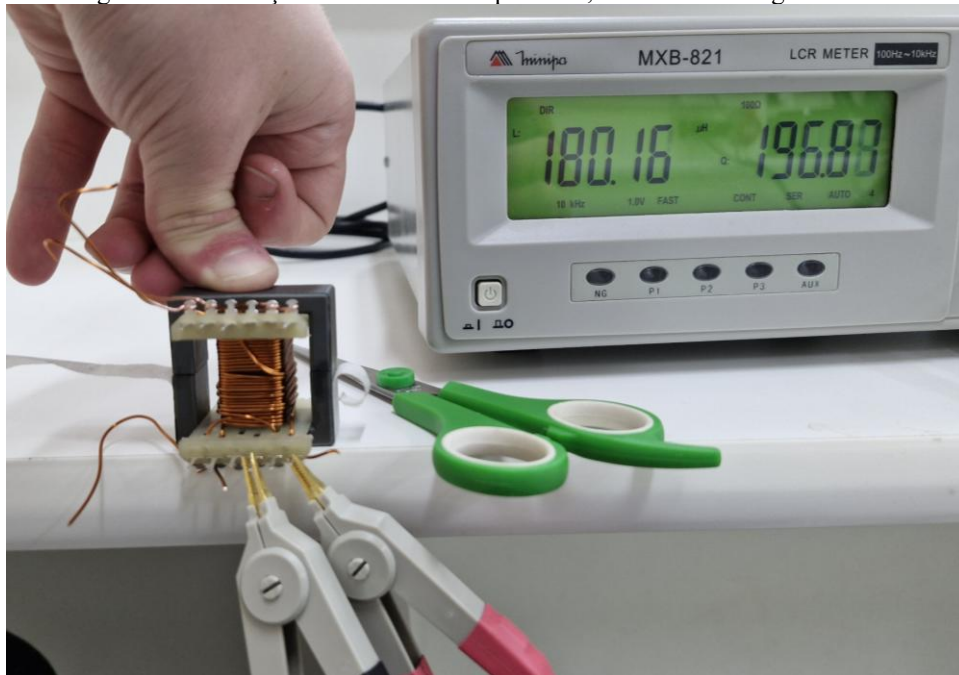
Figura 4.10: Medição da indutância do primário, durante a montagem do TR.
