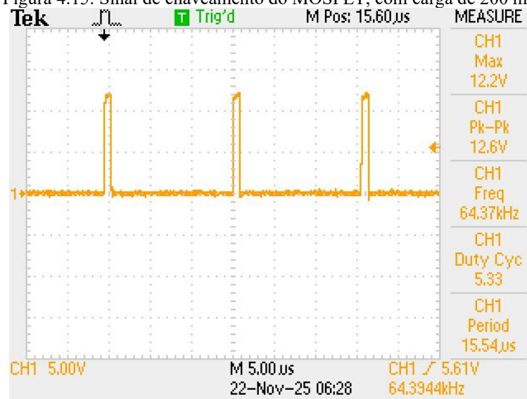
Figura 4.15: Sinal de chaveamento do MOSFET, com carga de 200 mA.
