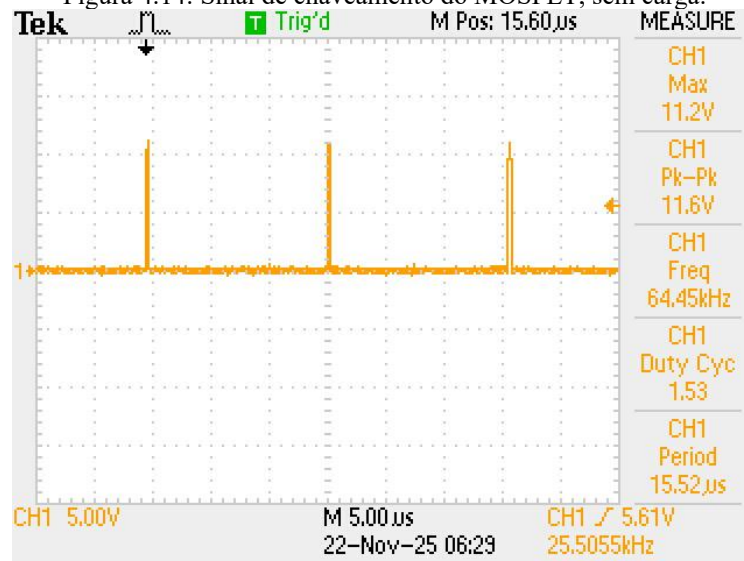
Figura 4.14: Sinal de chaveamento do MOSFET, sem carga.
