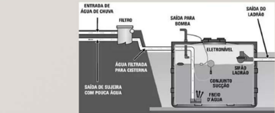
DETALHE CISTERNA ÁGUA PARA LIMPEZA DOS CANIS E CALÇADAS
