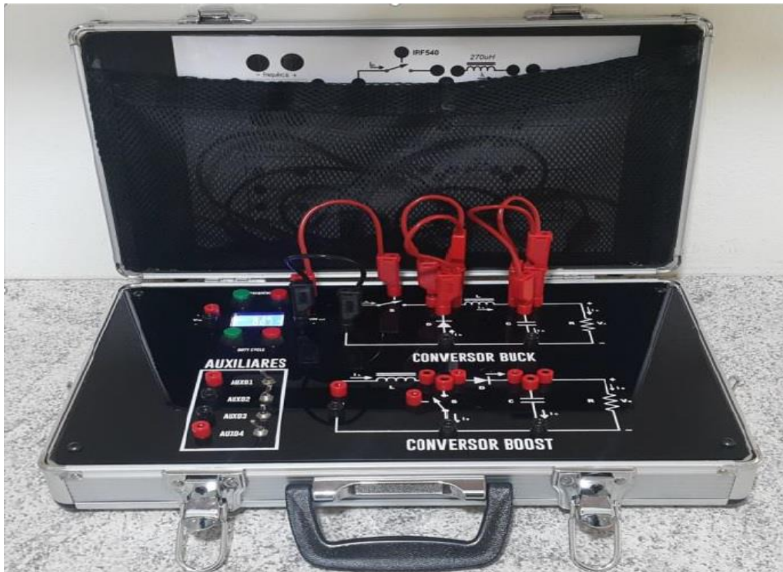
Figura 15 - Conversores Buck e Boost na maleta didática
