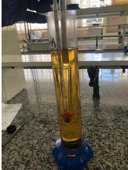
Figura 05 - Ensaio para determinação da massa específica a 20°C da amostra A.
