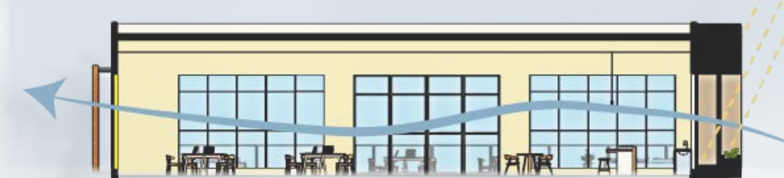
ESQUEMÁTICA CONFORTO TÉRMICO: VENTILAÇÃO CRUZADA, VEGETAÇÃO E INCIDÊNCIA SOLAR CONTROLADA POR BRISES.
