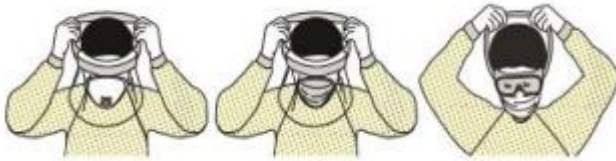
Figura 7: procedimento de retirada do protetor facial
